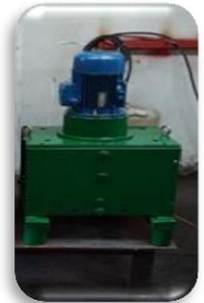
Водородогазогенератор факельной системы
