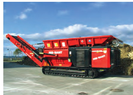
Установка для предварительного измельчения автомобильных шин
